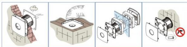
montáž do zdi montáž do stropu montáž do okna montáž bez vrtání
